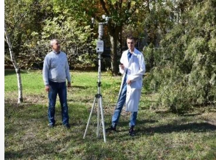
Измерение температуры воздуха, относительной влажности, количества осадков, скорости и направления ветра, атмосферного давления, влажности и температуры почвы. Передача данных осуществляется через сайт <http://meteo.inspector.ua>
