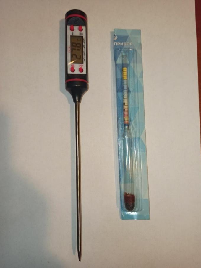
Определение температуры в различных объектах щуповым способом. Определение содержания спирта в спиртовых растворах.
