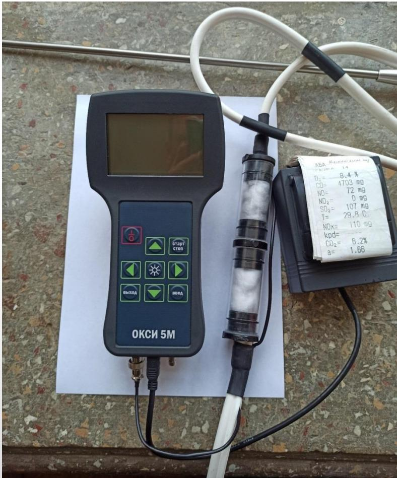
Измерение объёмной концентрации кислорода (O<sub>2</sub>), CO, NO, NO<sub>2</sub> и SO<sub>2</sub> в дымовых газах и в воздухе, температуры дымовых газов.
