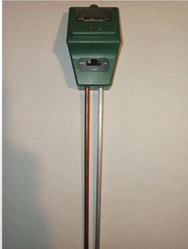
Определение влаги и кислотности почвы; определение освещённости на определённой территории.
