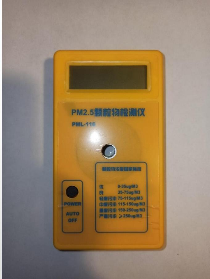
Определение частиц пыли размером 2,5 мкн в
