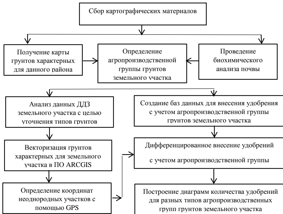
Рис. 1 – Блок-схема этапов применения ГИС в точном земледелии
