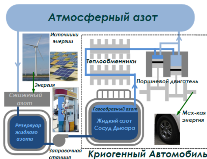
Рис. 1 – Схема функционирования криогенной силовой установки на жидком азоте.
